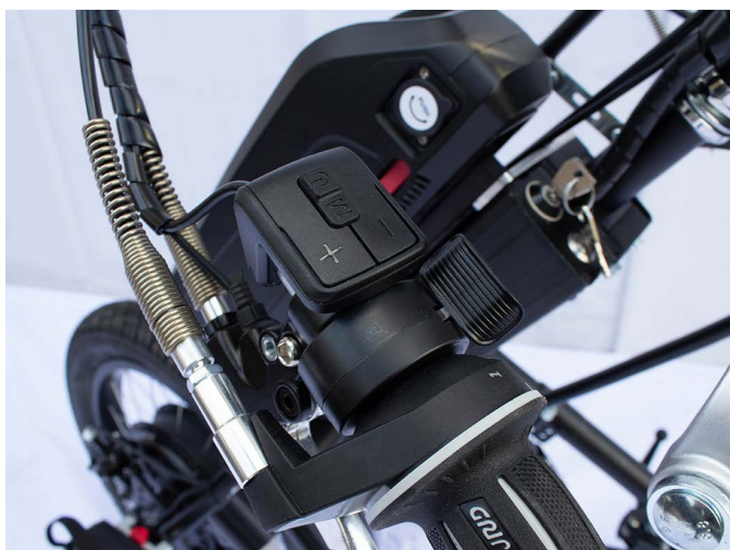
Fig. 12: Kontrollenhet på det vänstra handtaget
