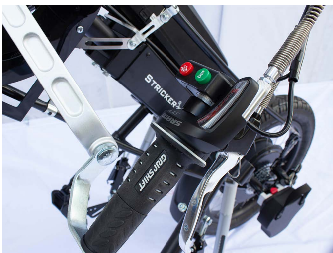
Fig. 19: Bromshandtag med bromskontakt och initiering av rekreation (avbrottskontakt är endast ansluten till höger bromshandtag).
