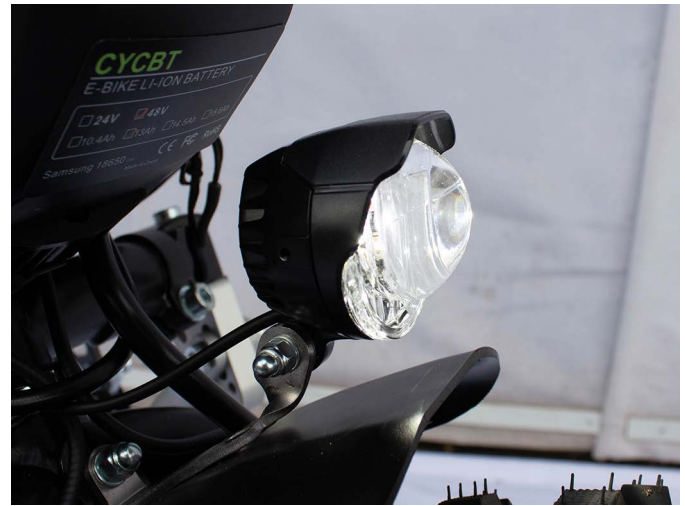
Fig. 17: Justering av lampans lutning med integrerat horn
