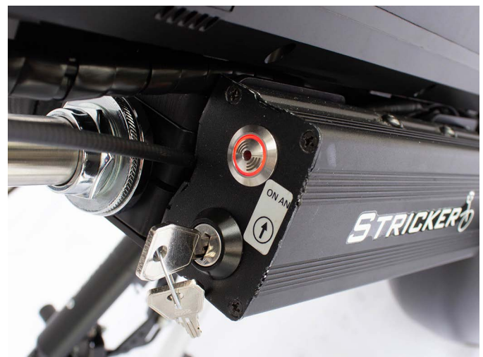
Fig. 18: Backljuset på kontrollenheten lyser när backväxeln är aktiverad
