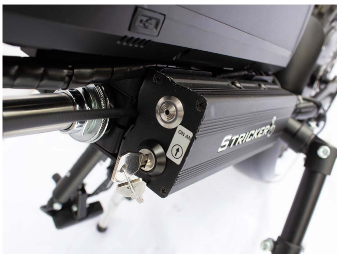
Fig. 11: Nyckelbrytning av batteri och kontroll
