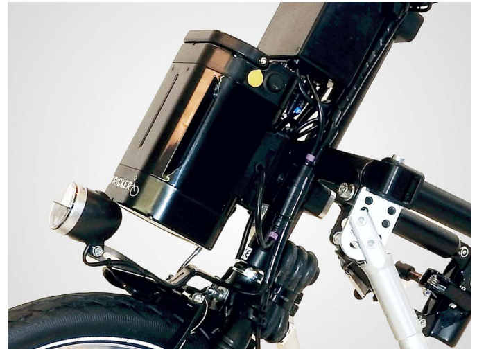
Fig. 20: Montering av batteriet
